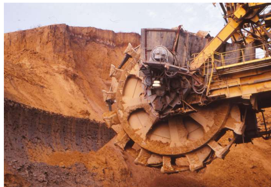
Celkový pohled na lom Chabařovice po skončení těžební činnosti, Výsuvové kolesové rypadlo KU 300 těžící uhelnou slaj, autor: Ing. Stanislav Štýs
